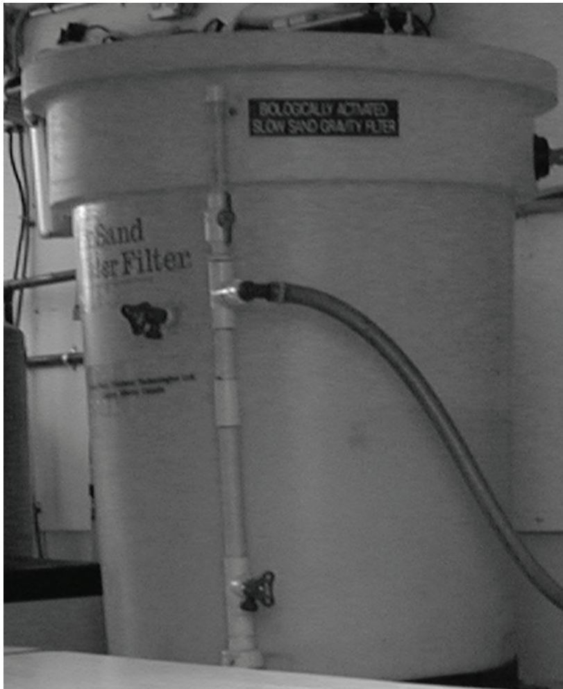
Figure 5.3 Filtre à sable lent
