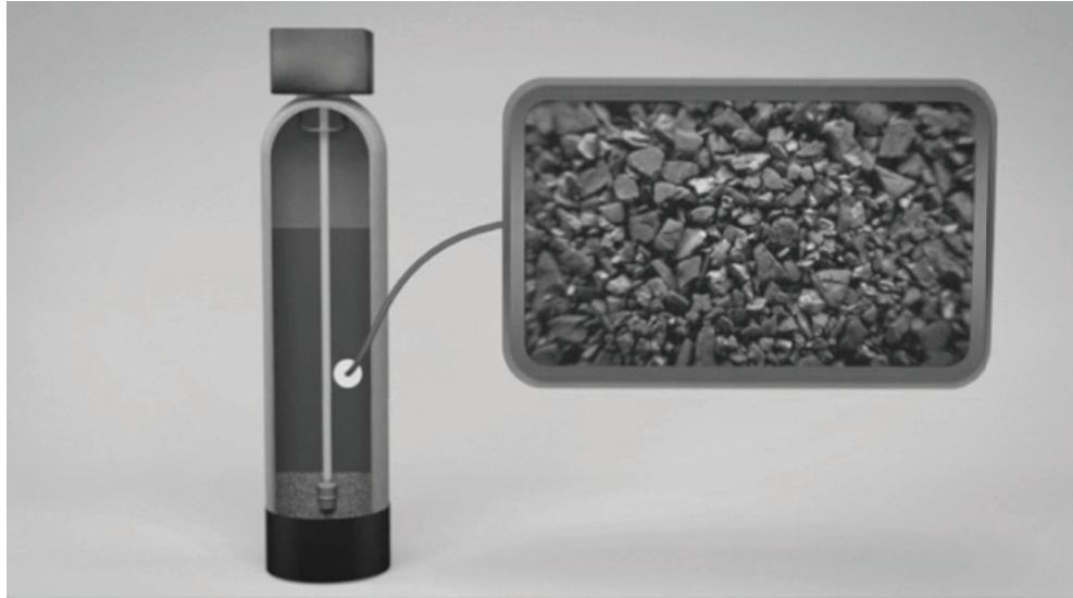
Figure 5.4 Filtre à charbon actif en grains
