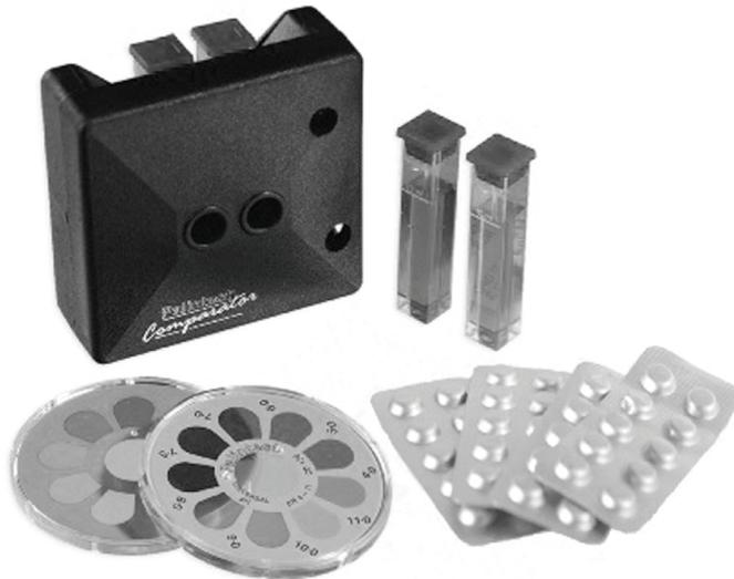
Una variación del método de DPD utiliza un dispositivo llamado colorímetro para medir directamente la intensidad del color de la muestra. Este dispositivo hace pasar una luz a través de la muestra de agua coloreada y determina la cantidad y tipo de luz que no puede pasar, lo que permite medir directamente el color de la muestra sin necesidad de compararlo visualmente con la escala de colores provista.
