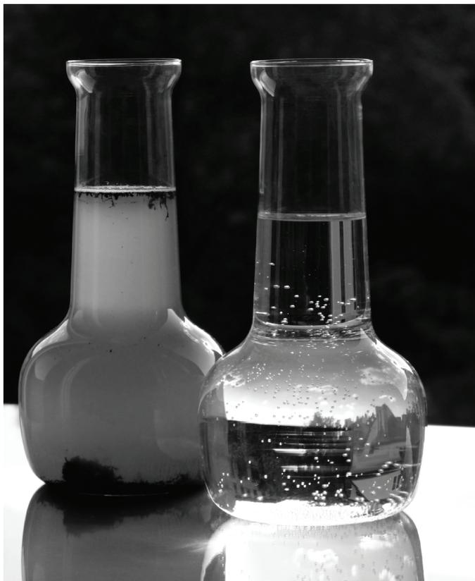
El agua turbia puede contener y ocultar microorganismos que causan enfermedades, reducir la eficacia del proceso de desinfección y de otros procesos de tratamiento, y aportar nutrientes para que los microorganismos vuelvan a crecer en las tuberías de distribución del agua.
